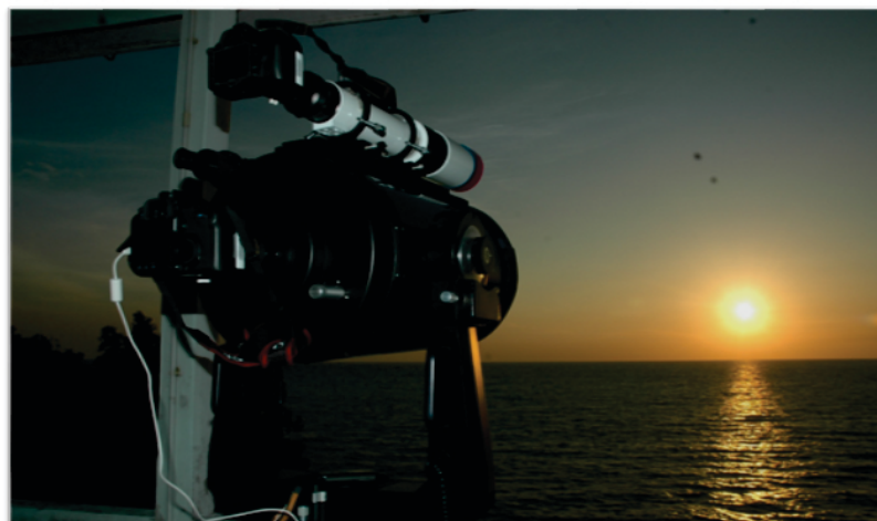
Rajah 4 : Dua kamera DSLR yang berbeza fungsi dipasang pada teleskop milik Makmal Fizik Angkasa, Universiti Malaya
